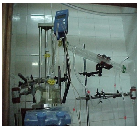
Instalația de preparare a solului
