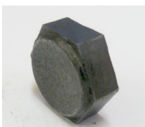
SrZrO 3 cu densitate > 99% din valoarea teoretică realizat prin Spark Plasma Sintering (stânga) și componenta de W realizată prin SPS într-un singur pas în forma finală (dreapta).
