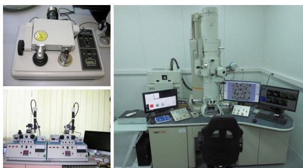
Echipamente specializate de preparare a probelor subțiri TEM prin procesare mecanică și subțiere ionică. Microscopul electronic analitic de înaltă rezoluție prin transmisie JEM 2100.
