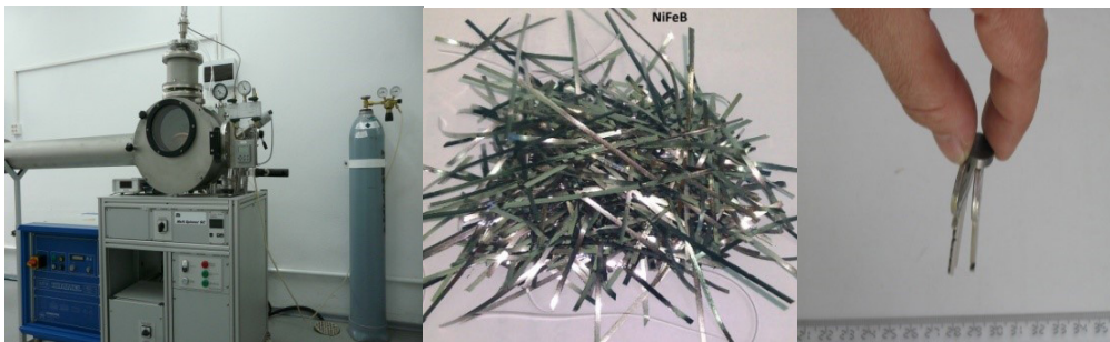
Instalație melt-spinning și tipuri de sisteme intermetalice obținute prin tehnici de neechilibru (benzi/pulberi macinate pentru magneți permanenți).
