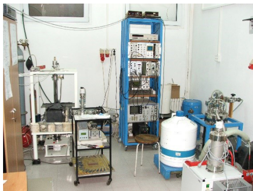
Spectrometru Mossbauer (SEECO, USA) cu criostat cu circuit închis de He (Janis, USA) și două exemple de spectre (temperaturi diferite pe un nanocompozit Fe-C și concentrații diverse de Ba pe o hexaferită de Ba.
